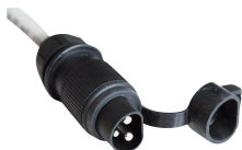
10229 - Stecker DIN 9680, 3-polig 6 - 24 VDC, max. 25 A, IP 54
