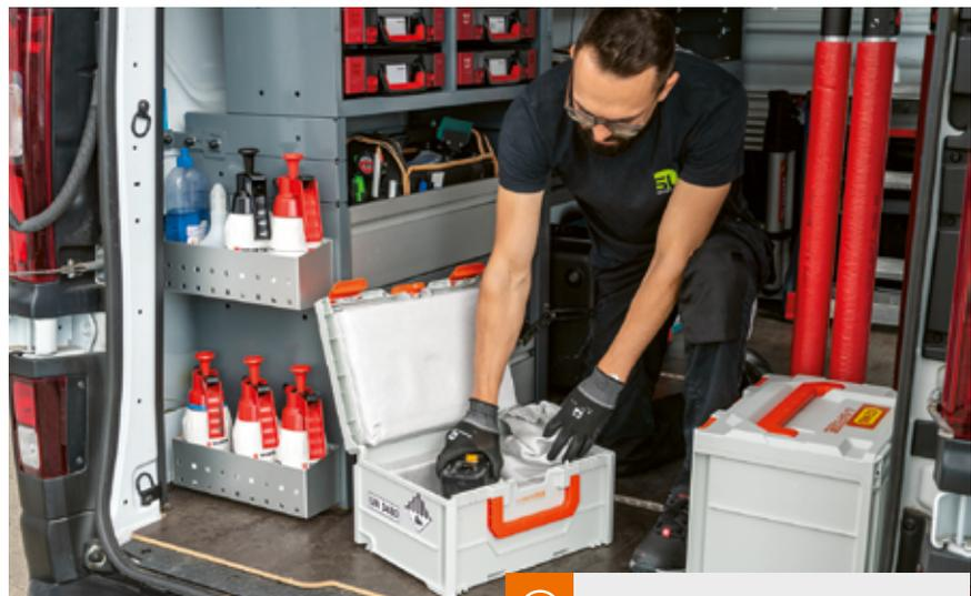
Defekte Akkus müssen bei der Arbeit sicher transportiert werden.
