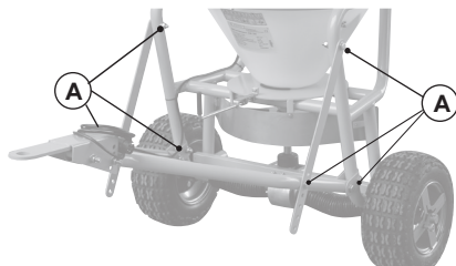
Figure 6.2.1.1: Montage du timon compl.
