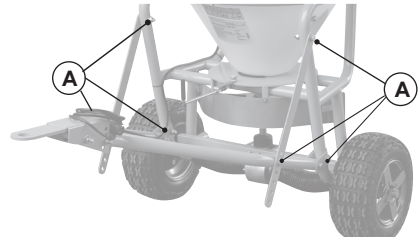
Bild 6.2.1.1: Montage Deichsel kpl.
