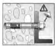
4: Position prüfen: Ein Gewindegang Überstand über die Mutter
