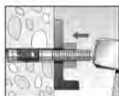
3: Anker mit Setzlehre setzen
