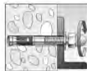
5: fischer FAZ II Hutmutter aufdrehen
