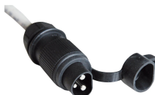
10229 - Stecker DIN 9680, 3-polig 6 - 24 VDC, max. 25 A, IP 54
