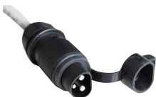
10229 - Stecker DIN 9680, 3-polig 6 - 24 VDC, max. 25 A, IP 54
