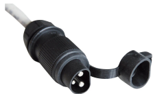
10229 - Stecker DIN 9680, 3-polig 6 - 24 VDC, max. 25 A, IP 54
