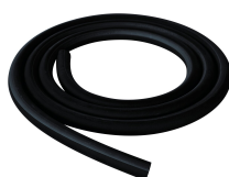
11351 - Zapfschlauch für Diesel, DN 19, NBR 10 bar, elektr. leitfähig, -20°C - 80°C
